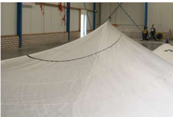
Das Testsegel nach der Behandlung: Das Profil ist cirka 20 Prozent flacher geworden, seine größte Tiefe liegt nun wieder an der ursprünglich vorgesehenen Position.
